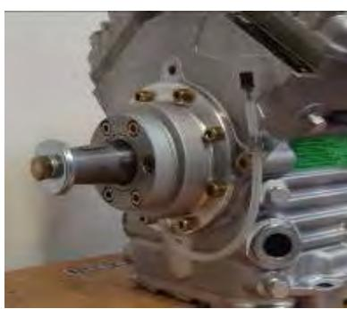
**Каде заптивките на полухерметските компресори и компресорите кои имаат одводен погон.**
