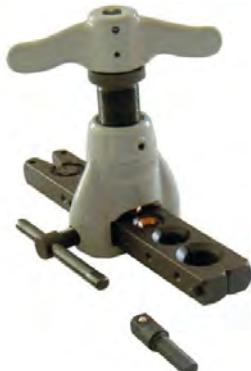
Формирањето конуси на бакарните цевки се применува при изведба на раздвоен (холендерски) тип на поврзување на бакарните цевки со одредени компоненти од системот.
