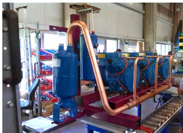
Слика 13: Поврзување на елементи со машински свиткани цевки.
