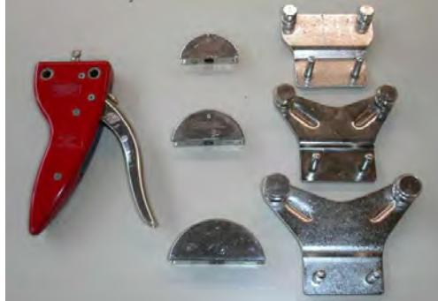
Слика 16. Рамов притисен рачен виткач.
