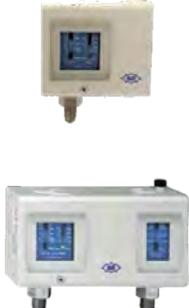
Не постои систем за ладење без заштита од висок и од низок притисок. Оваа заштита може да биде изведена со помош на механички пресостати или електрични индикатори на притисок. Механичките пресостати можат да бидат саморесетирачки или со ресет-опција. Се препорачува заштитата од висок притисок да биде со ресет-опција.
