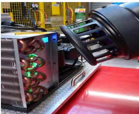
На кривини од изменувачите (кондензатори или воздушни испарувачи). Заради корозија на бакарната цевка од агресивна средина во индустриски погони. Дебелината на овие елементи е помала од дебелината на бакарните цевки, кои се користат при поврзување на компонентите на системот.
