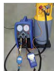
Поврзување на сервисен цилиндер со заштита од преполнување
