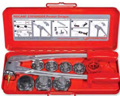
Проширувањето на бакарните цевки заради изведба на нераздвоен тип на врска се врши со помош на експандер за бакарни цевки. Продолжувањето на овој начин овозможува еден спој помалку (споредено со користење на бакарен фитинг), а тоа значи едно критично место за истекување помалку.
