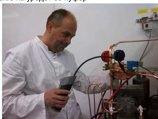
Слика 2: Електронски детектор на истекување од третата генерација и проверка на истекувањето на уредот за ладење со електронски детектор на истекување.
