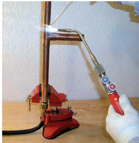
Слика 30: Поврзување и користење на азот при процесот на лемење.
