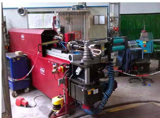
Слика 12: Машинско виткање на цевки.
