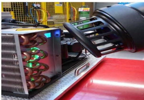
На кривините од изменувачите (кондензатори или воздушни испарувачи). Заради корозија на бакарната цевка од агресивна средина во индустриски погони. Дебелината на овие елементи е помла од дебелината на бакарните цевки кои се користат при поврзување на компонентите на системот
